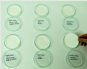
Поместите по два круглых фильтра диаметром 90 мм в каждую из шести чашек Петри диаметром 100 мм и разровняйте их по дну чашек (верхний рисунок).
